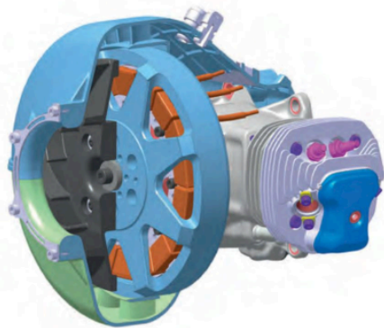
Das 3D-Modell eines hybriden elektrischen Antriebsstrangs
